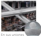
el acero de las varillas se torna contínuo, sin burbujas, con un acabado limpio y de alta resistencia.
